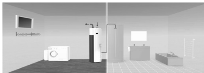
Aufstellung im Waschraum Warmwasserbereitung aus Raumluft, Trocknung des Raumes
